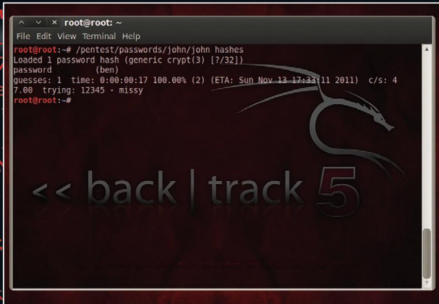
Можно ускорить *John The Ripper*, скомпилировав его с оптимизацией для вашего CPU. Конечно, если пользователь использует пароль «password», это излишне.
