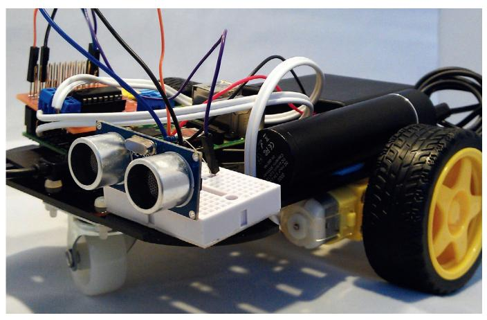
> У нашего робота два колеса по бокам, которые обеспечивают перемещение, и поворотный ролик спереди.
