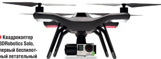
накопители камер. Мобильное приложе- ние обеспечивает управление Solo, позво- ляя делать фотоснимки и менять настрой- ки, в т.ч. зону обзора (FOV), частоту кадров и экспозицию.
