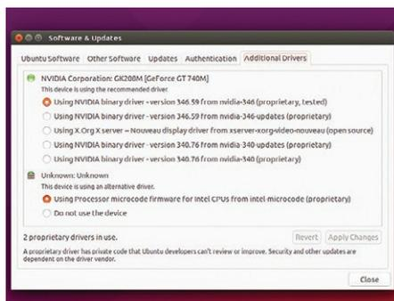
➤ Используйте инструмент **Additional Drivers** в Ubuntu для установки проприетарных драйверов для видеокарты и другого оборудования.
