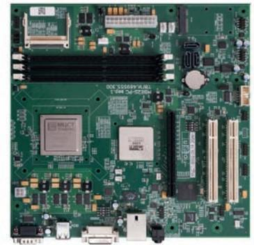
Эльбрус 401Б-PC позволяет запускать и другие ОС для платформы x86/x86-64; эта возможность обеспечена программно-аппаратной системой двоичной трансляции.
