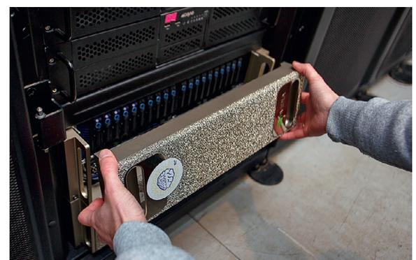
» Последние моменты установки вычислительного узла DGX-1 в серверную стойку.
