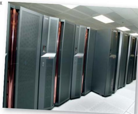
**ASC Purple использует стандартные компоненты производства IBM и свыше 12 000 процессоров Power5**
