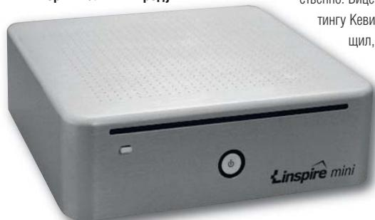
через щель, процессором Pentium M для ноутбуков, портами FireWire и USB, а также выходом на любое стандартное устройство CRT/LCD или DVI. Еще можно подключить HDTV для DVD и настроить воспроизведение потоковых клипов.
